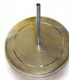
Inclinómetro mecánico M304 para la obtención del ángulo de incidencia solar sobre los módulos
